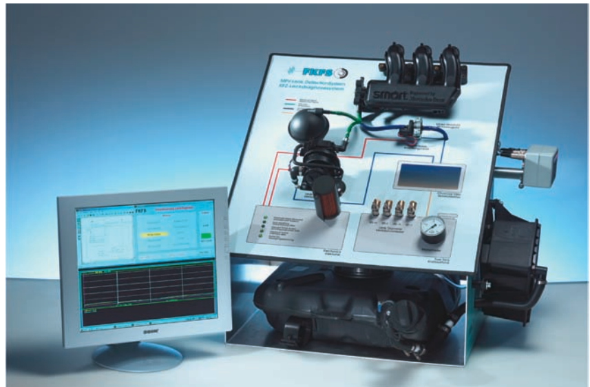
Demonstrator zur modellbasierten Tankleckdiagnose ohne zusätzliche Sensorik
