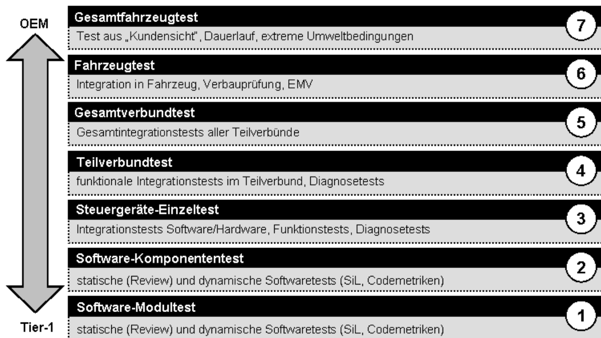
Abb. 2: Die sieben Testebenen des Absicherungspfades im V-Modell.
