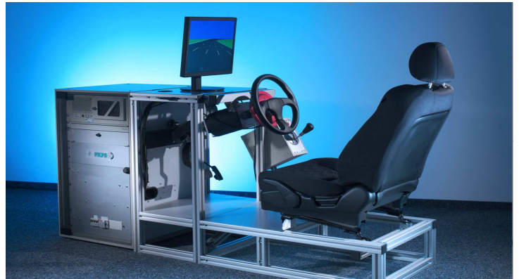
Lenkhaptik-Simulator zur Entwicklung neuer Lenkungskonzepte und -Funktionen
