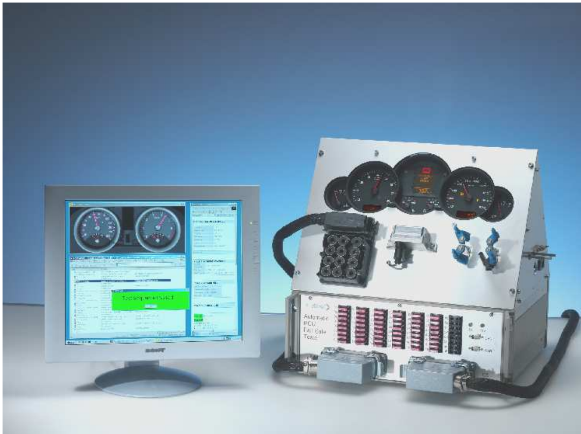
Bild 4: P.A.T.E.-Testumgebung für Fahrdynamikregelung
