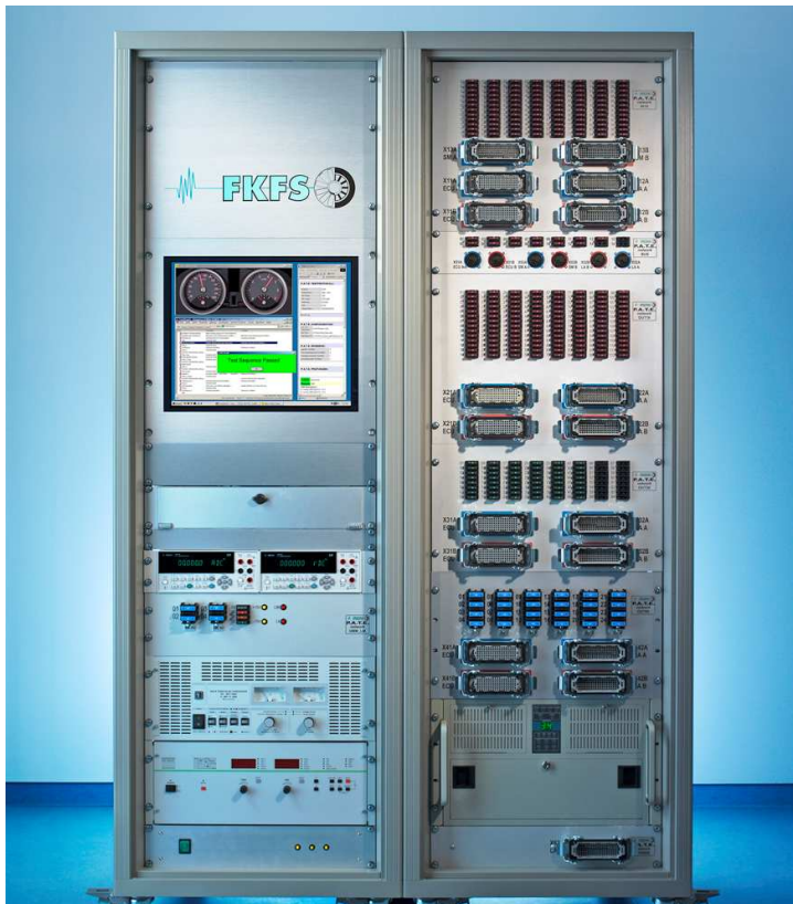
Bild 8: Verbundtester für Karosserie- und Innenraumelektronik
