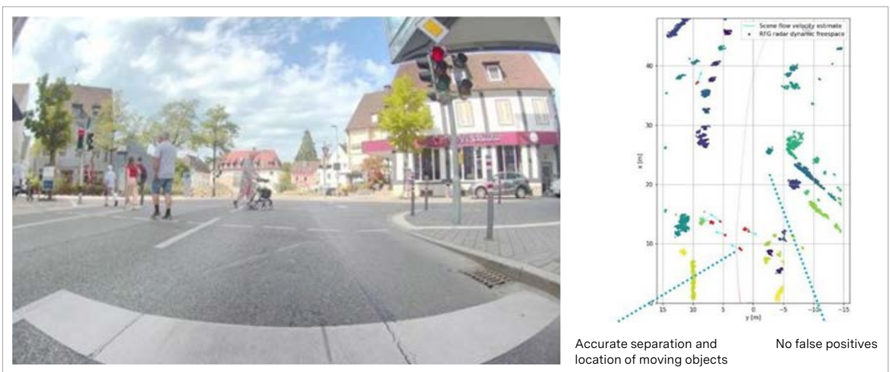
Abbildung 7: Exemplarische Darstellung der Objekterkennung mittels Radar
