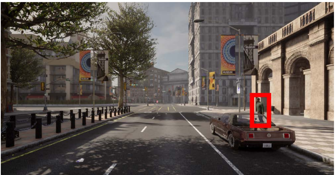
Abbildung 43: Potenzielle Gefahrenszenen in der virtuellen Umgebung (aufgrund von Verdeckungen)
