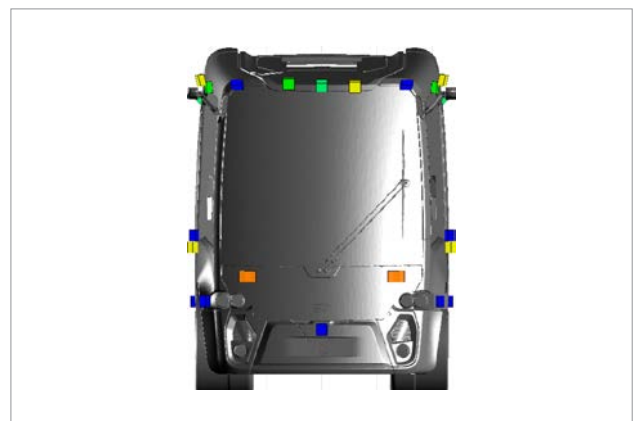
Abbildung 4: Front Sensor-Set (Front-Ansicht) mit Kameras (gelb), Radaren (blau), Lidaren (grün) und Mikrofonen (orange)
