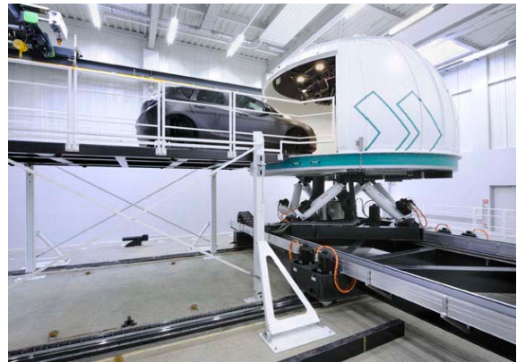
Simulationsdom, Fahrzeugwechsel-einrichtung und Pilotfahrzeug
